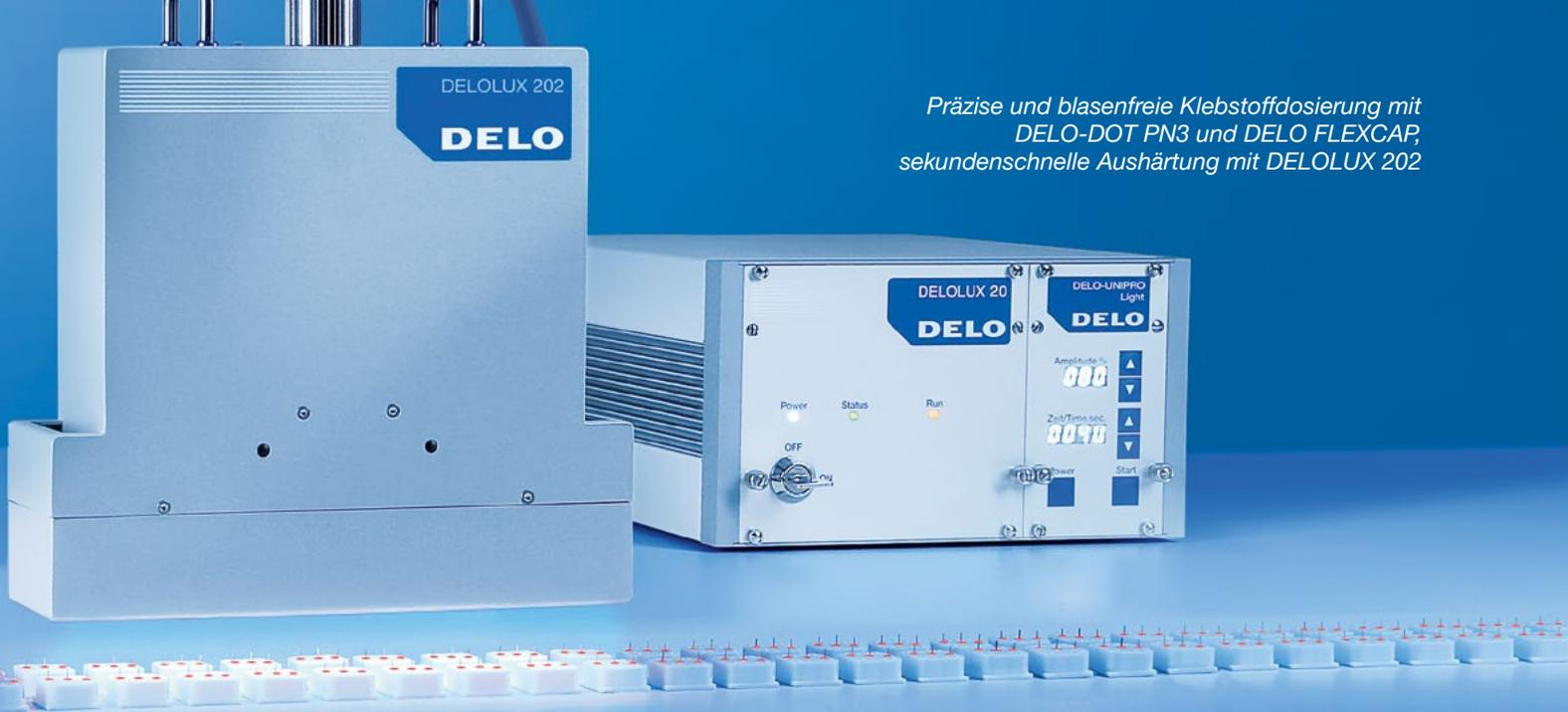
Präzise und blasenfreie Klebstoffdosierung mit DELO-DOT PN3 und DELO FLEXCAP, sekundenschnelle Aushärtung mit DELOLUX 202
